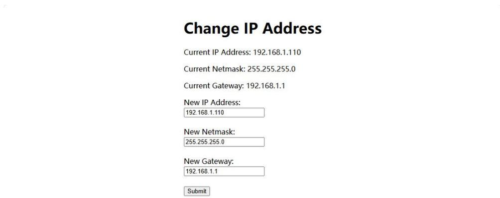
3. 在输入框内输入新的 IP, Netmask 和 Gateway，然后点击 Submit 即可修改 NTP 服务器当前的 IP, Netmask 和 Gateway，以上参数掉电不丢失。
